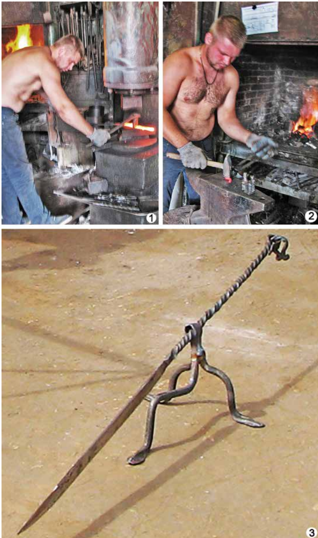
Рис. 5. Виготовлення моделі рожна. 1, 2 – процес виготовлення; 3 – готова модель
